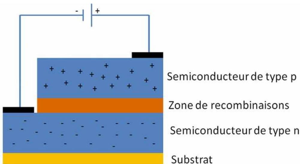
Une diode est constituée de deux zones, l'une possédant un excès d'électrons (zone dopée  $n$ ), l'autre possédant un déficit d'électrons (zone dopée  $p$ ) appelés trous. Le passage d'un électron de la zone  $n$  à la zone  $p$  ne se produit que si cet électron possède une énergie minimale ou énergie de seuil.
