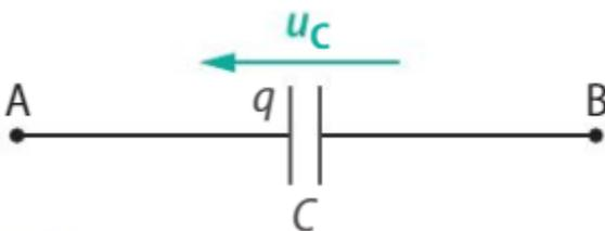
La capacité **C** d'un condensateur vérifie la relation :  $q = C \cdot U_c$
